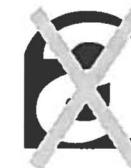
Bu motorda kullanılan contalar asbest malzemesi bulunmaz. Bakım ve tamir çalışmalarında lütfen uygun yedek parçalar kullanın.
